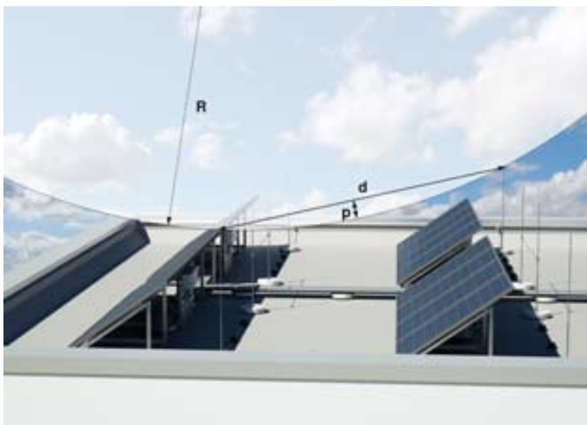
p = Eindringtiefe, R = Radius der Blitzkugel, d = Abstand der Fangeinrichtung
